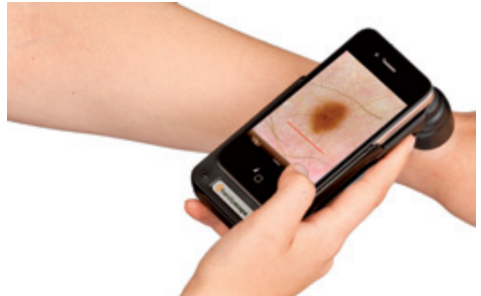
Handdermatoskop mit Smartphone für mobile Hautuntersuchungen (Quelle: www.handyscope.net )
