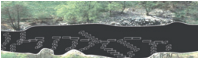
Skizzierte Fischtreppenlösung nach Renaturierung eines Baches mit 50-150 Pico Wave Power Modulen (mechanisch-elektrische Umwandlungseinheiten) (Quelle: BioEnergie Verbund Thüringen e. V.)
