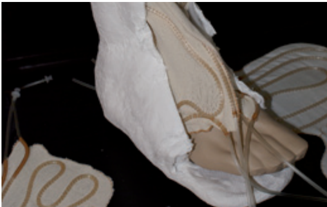
Die in einem highSTICK-Verbundprojekt entwickelte Kühlmanschette (Quelle: INNtexas Innovation Netzwerk Textil e. V.)
