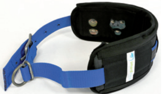
Abbildung: Halsgurt für die Messung am Rind (Abbildung: Frankenförder Forschungsgesellschaft mbH)
