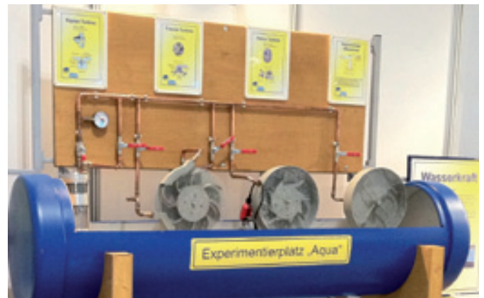
Experimentieranlage des Netzwerks mit verschiedenen Turbinen (Quelle: BioEnergie Verbund Thüringen e. V.)
