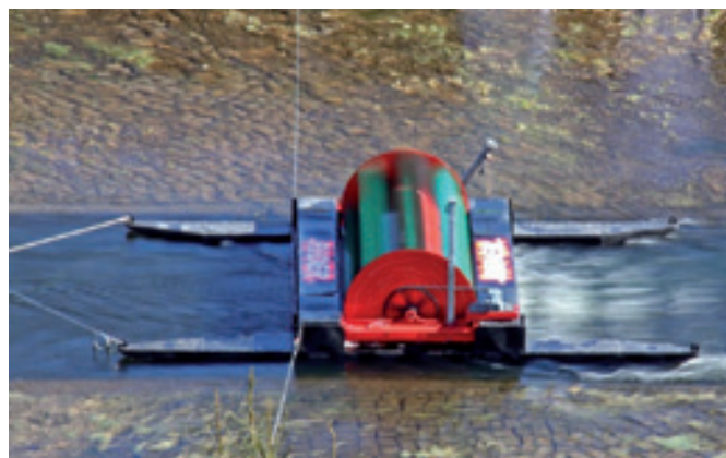
Das von Netzwerkpartnern entwickelte Flusskraftwerkmodell River Rider am Auslauf der Wendefurter Talsperre (Quelle: Netzwerk Fluss-Strom)
